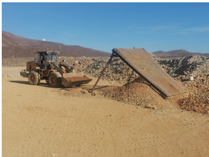
Зураг №-6 Олборлосон хүдрийг шигшиж 2 фракц болгон ангилах нь бутлагдах хүдрийн хэмжээг багасгах сайн талтайгаас гадна бутлах үед үүсэх тоосжилтыг багасгах сайн талтай.
