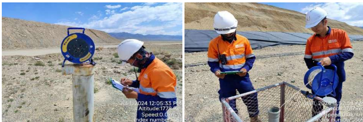
Зураг 53. Нуруулдан уусгах байгууламжийн пизометрийн цооногийн хяналт
