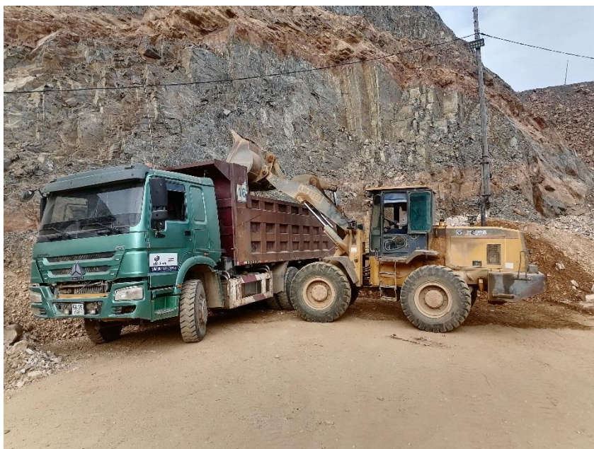
Зураг №-15 Далд уурхайгаас олборлосон хүдрийг 30тн –ын даацтай өөрөө буулгагчаар 0.4км технологийн замаар зөөвөрлөн анхдагч хүдэр хүлээн авах талбайд хүргэнэ. Энэхүү тээвэрлэлт нь хоногт 2-4-н удаа хийгдэх тул тоосжилт эрс багассан.
