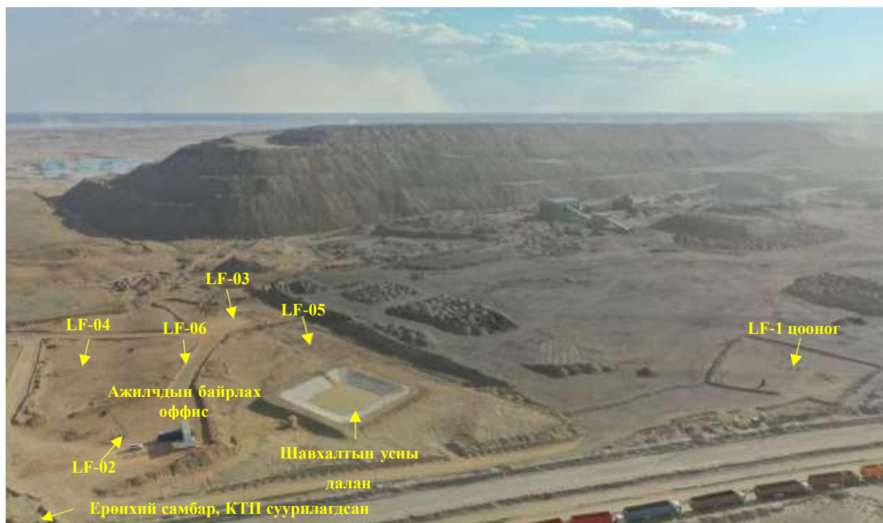
Зураг 6. Туришилт-олборлолтын цооногийн талбайд байгуулагдсан шавхалтын ус түр цуглуулах далан болон туришилт-олборлолтын цооногуудын байрлалыг харуулсан дрон зураг
