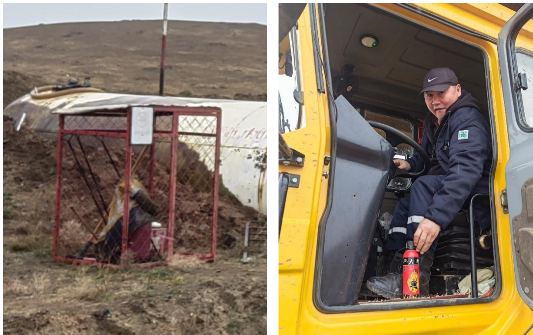
Зураг № 24 Галын сарааг ШТС талбайд байршуулсан байдал, уурхайн техник бүрд галын аюулгүй байдлыг хангаж буй байдал
