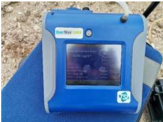
Агаарын нийт тоосонцор хэмжих DUST TRAK DRX 8530
