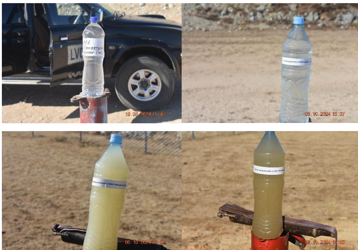
Зураг 28: Мониторингийн цооногуудын гүний усны дээжлэлт
