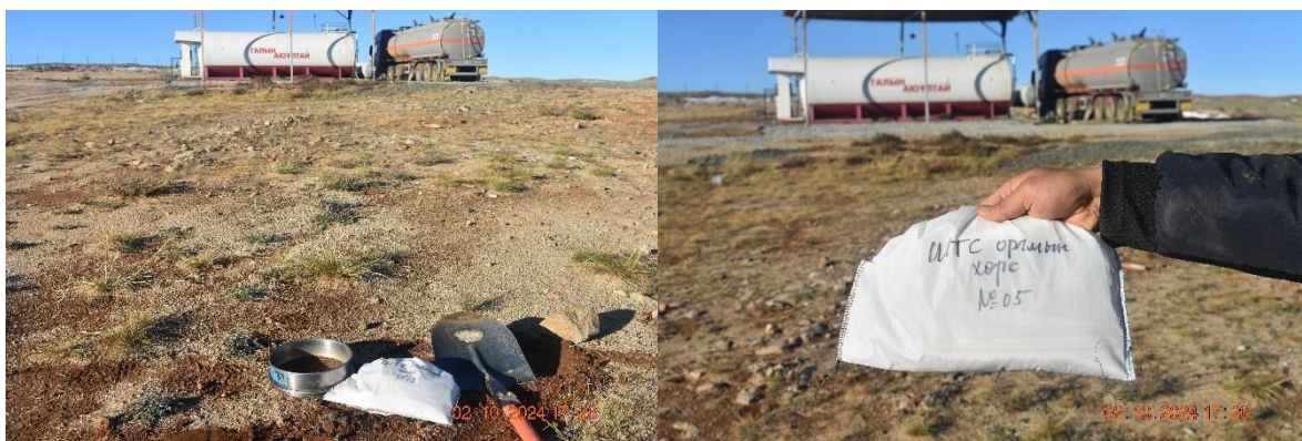
Зураг 14: Шатахуун түгээх хэсгийн хөрснөөс дээжлэлт хийсэн байдал
