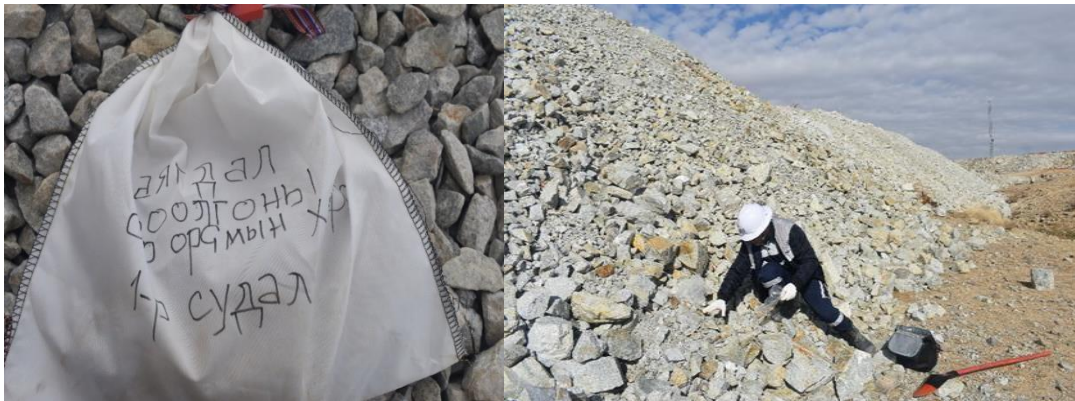
Зураг 5: Хаягдал чулуулгийн овоолго болон ойр орчмын хөрснөөс дээж авч буй байдал
