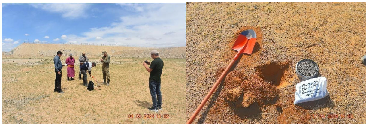
Зураг 64: Хаягдлын далангийн ойр орчмын хөрснөөс дээжлэлт хийсэн байдал
