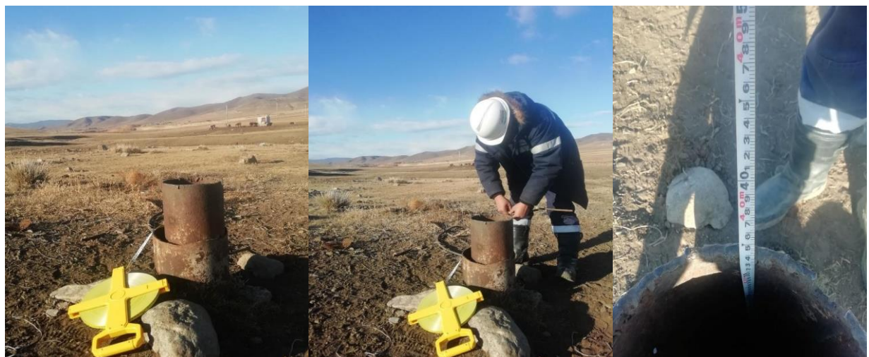
Зураг.5 Гидромониторингийн цооног / Усны түвшин хэмжигч Хлопушка /
