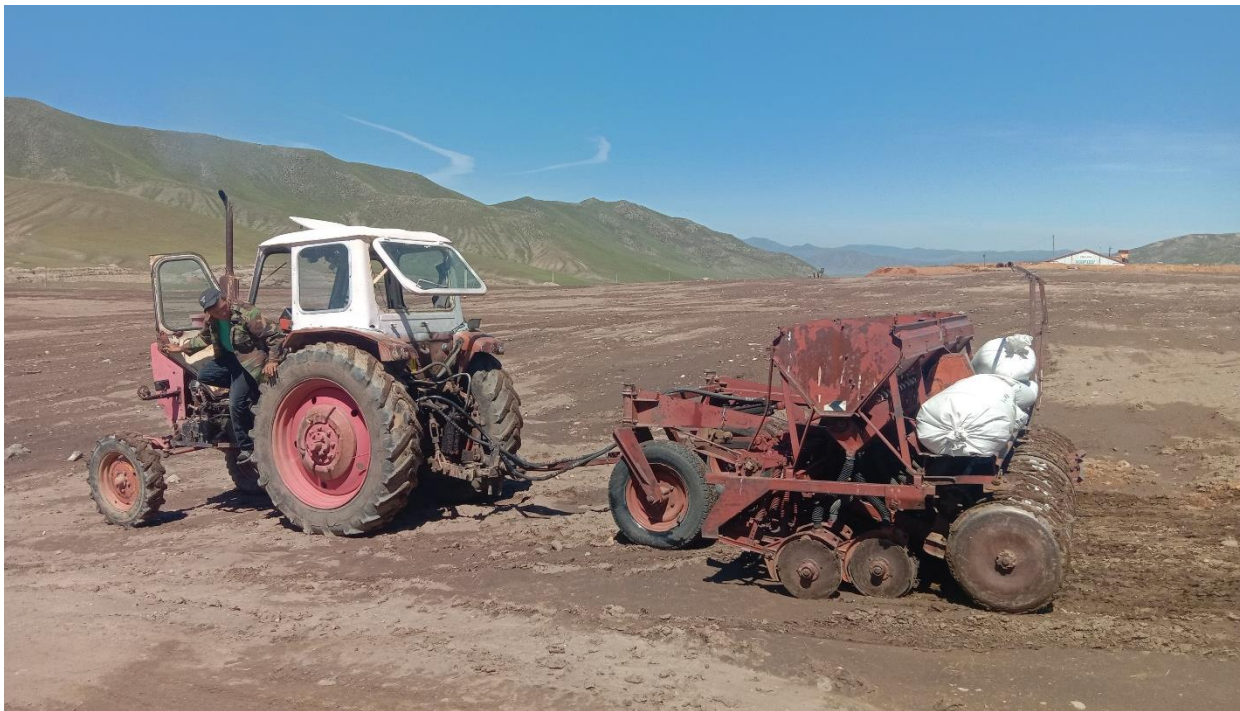
Зураг.20 Нийт 750 кг олон наст ургамлын үрээр газар тариалангын силк ашиглан тарилт хийгдэв. 14.23 га талбайд ЮМЗ трактораар 15 см-ийн мөр хоорондын зайтайгаар 4-5 см-ийн гүнд 2024 оны 6 сарын 23-25 нд тарилт хийв.
