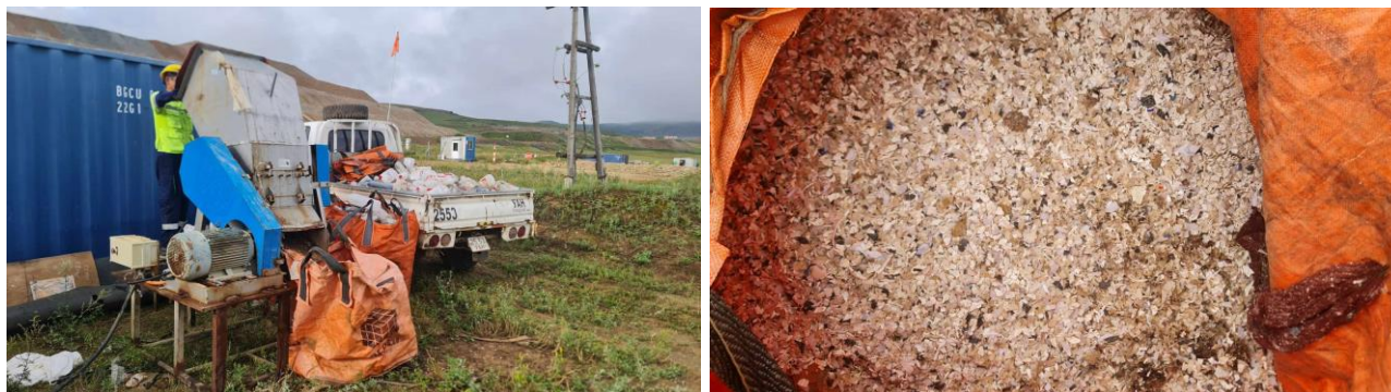
Зураг 128. Хаягдал хуванцар бутлаж буй байдал
