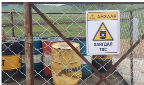
Аюултай хог хаягдлын хашааг орчноос тусгаарлаж хөмсөгжүүлсэн байдал
