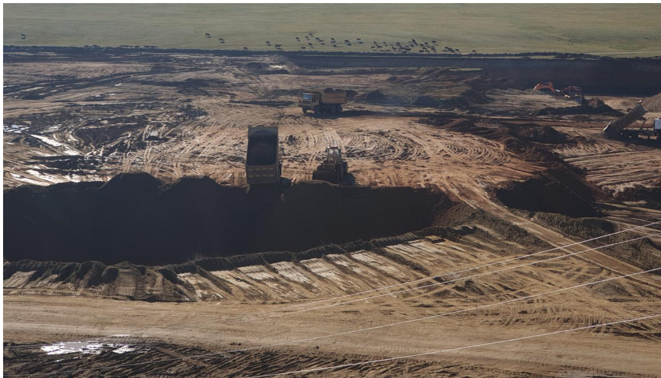
Зураг 6. Дотоод овоолгоор нөхөн дүүргэлт хийж буй ажлын явц
