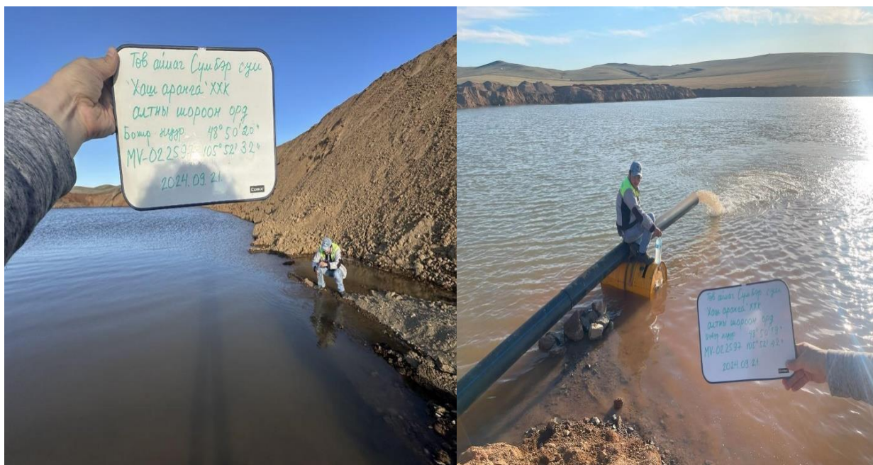
Зураг .28 Уурхайн элс баяжуудах бохирийн болон цэврийн нуурын уснаас дээж авч буй байдал
