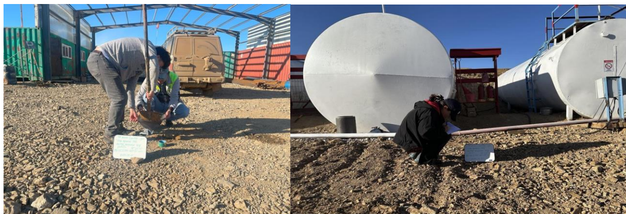
Зураг.25 Уурхайн засварын талбай болон ШТС-аас хөрсний дээж авч буй байдал
