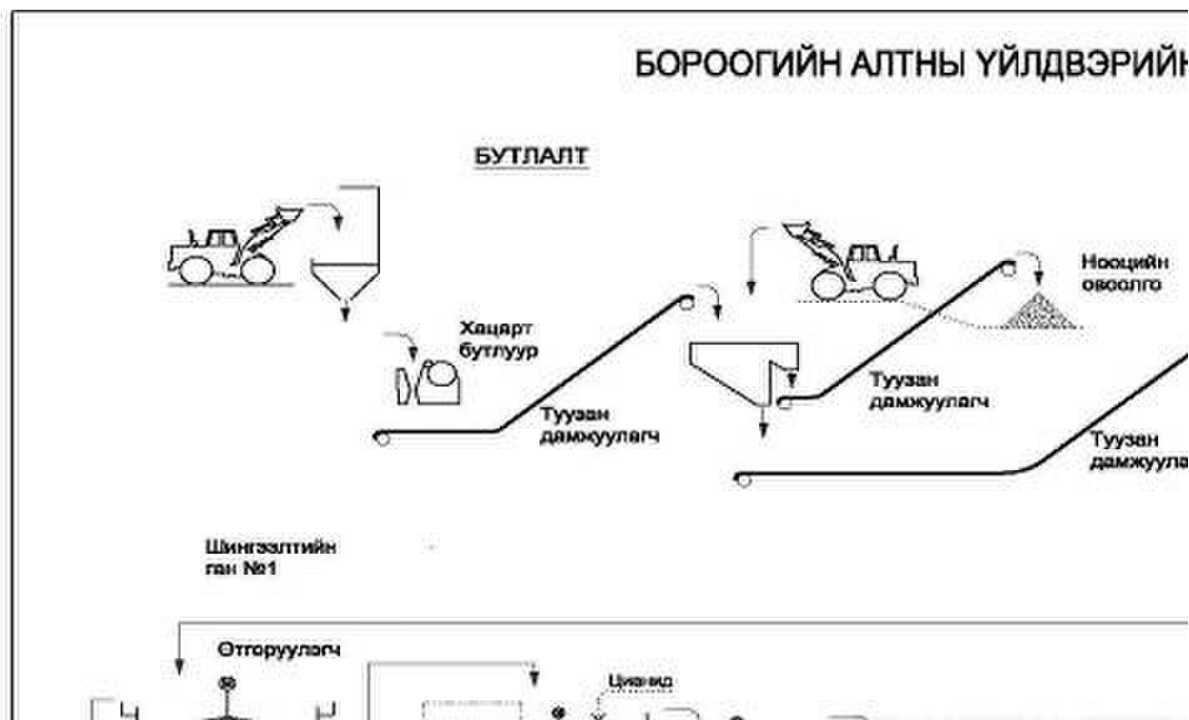
Зураг 2. Боловсруулах үйлдвэрийн технологийн схем
