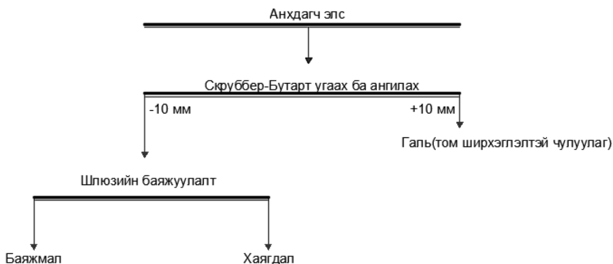
Зураг 2. “Их өвөлжөө” алтны үүсмэл шороон ордын элсийг баяжуулах технологийн схем
