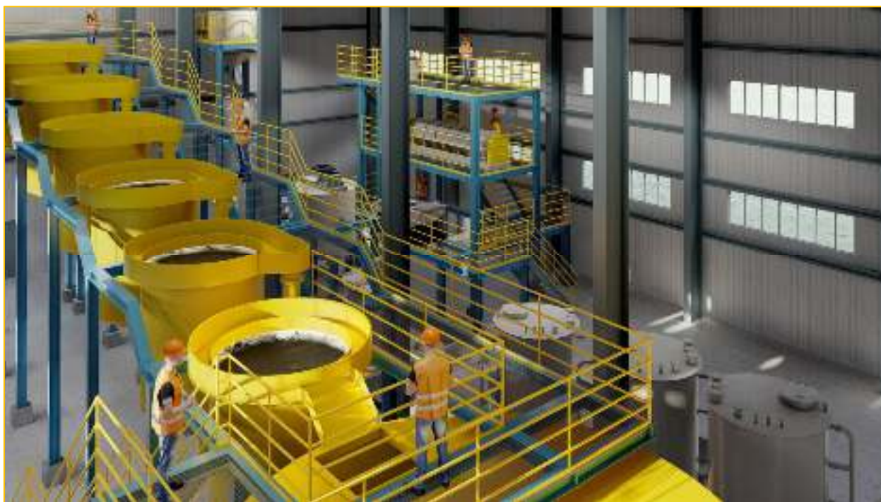
Зураг 16. Нүүрсэнд алт шингээх танкны хэсгийн 3D эскиз зураг
