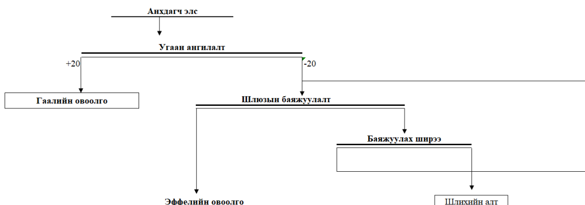
Зураг № 2 Угаан баяжуулах технологийн схем
