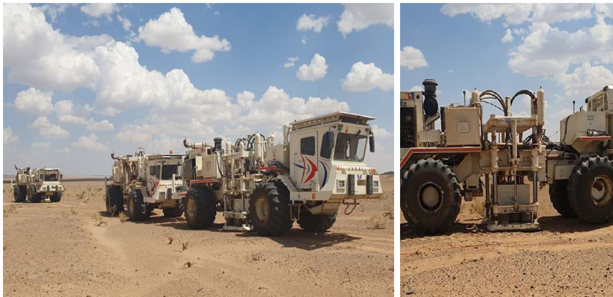
Зураг 6. Вибраторын машин уян харимхай долгион үүсгэж буй нь
