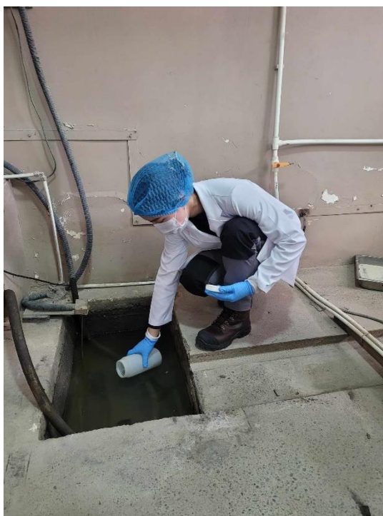
Зураг 1. Технологи туршилтанд ашиглагддаг шлихийн дээж угаалтаас гарах хаягдал уснаас шинжилгээний дээж авч буй байдал
