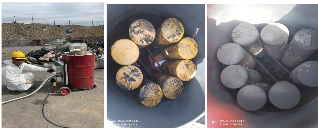
Зураг 4.1.3 Турбо бурнер ашиглан тосыг цэвэрлэж байгаа байдал
