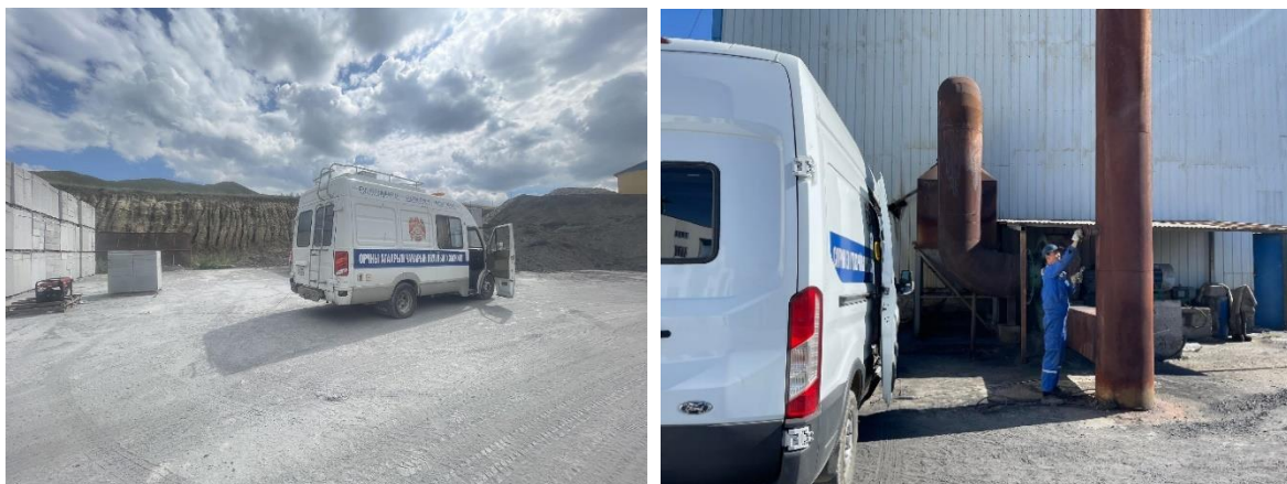
Зураг 32. Уурын зуухны яндангаас ялгарах бохирдуулагчийн хэмжилт хийж буй байдал
