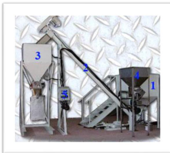
Зураг 7. Энгийн тэсрэх бодис үйлдвэрлэх суурин тоног төхөөрөмжийн схем Тайлбар: Аммиакийн шүүний бункер-1, Холигч шурган дамжуулагч-2, Савлагч тоног төхөөрөмж-3, Дизель түлшний бункер болон шахах насос-4, Автомат хяналтын самбар-5
