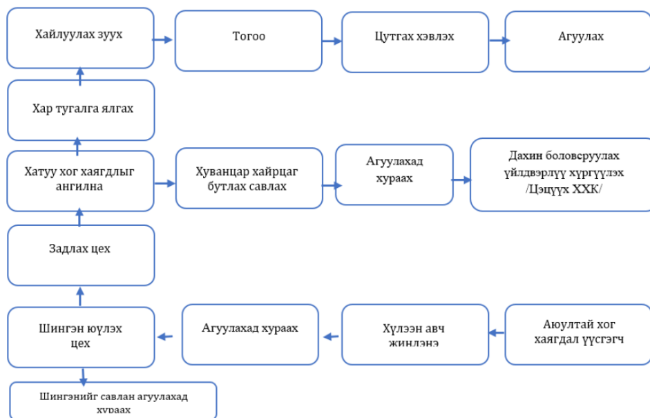
Зураг 4. Хаягдал батареи боловсруулах технологийн дамжлагын схем
