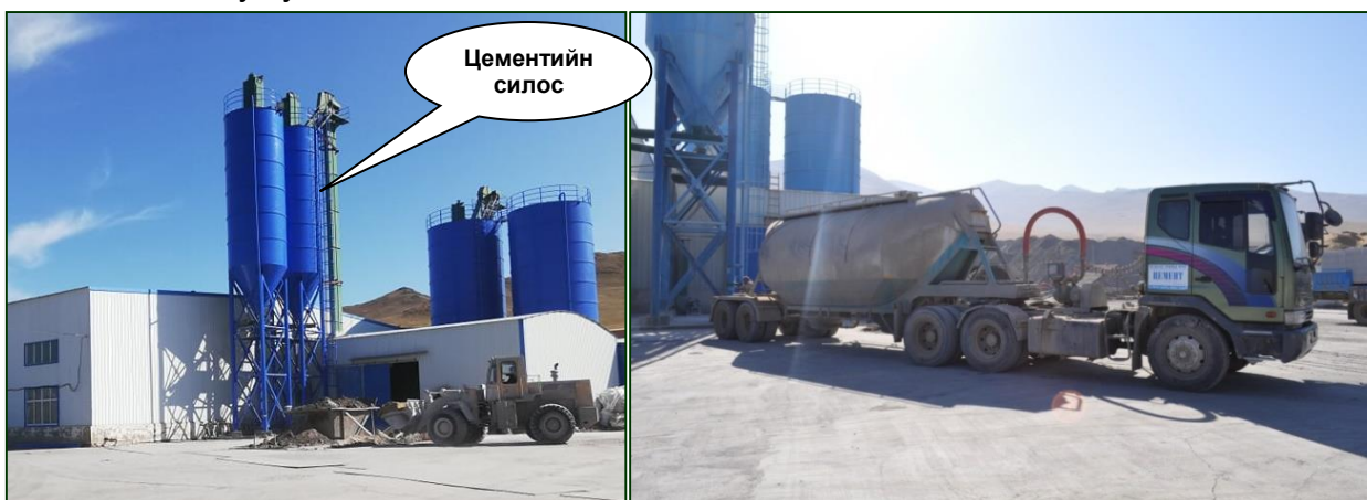
Зураг 3. Цементийн силос буюу силосд цемент шахаж буй байдал
