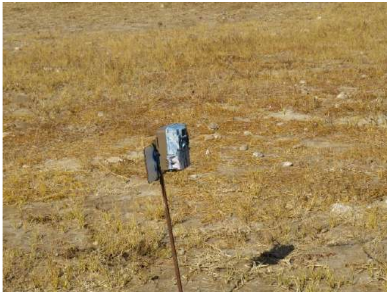
Зураг 2-55. Хөдөлгөөн мэдрэгч автомат камер байрлуулсан байдал
