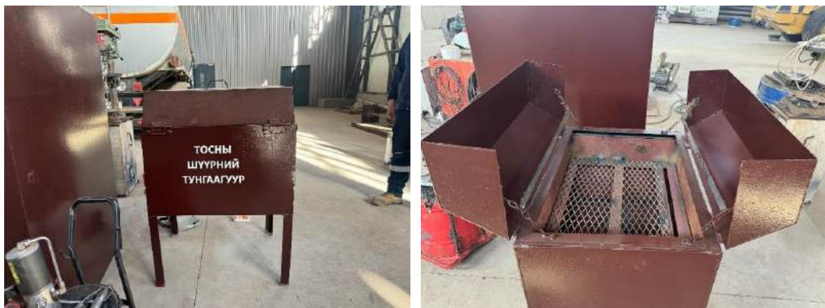
Зураг 7-10. Тосны шүүрнээс хаягдал тос ялгах тунгаагуур
