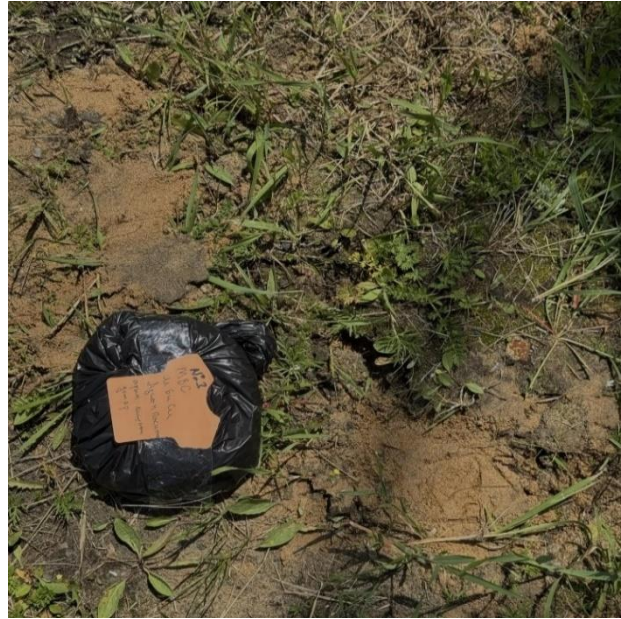
Зураг 2.2-2.3. Хөрсний шинжилгээний дээж авч буй байдал
