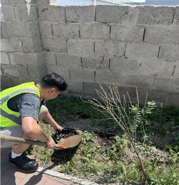
Зураг 2.2-2.3. Хөрсний шинжилгээний дээж авч буй байдал
