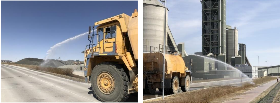
Зураг 4. Зам талбайн усалгаа хийж буй байдал
