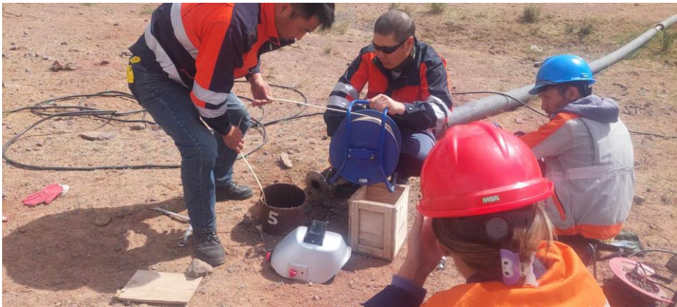
Зураг 42. Үйлдвэрийн хяналтын цооногуудад хэмжилт хийж буй байдал
