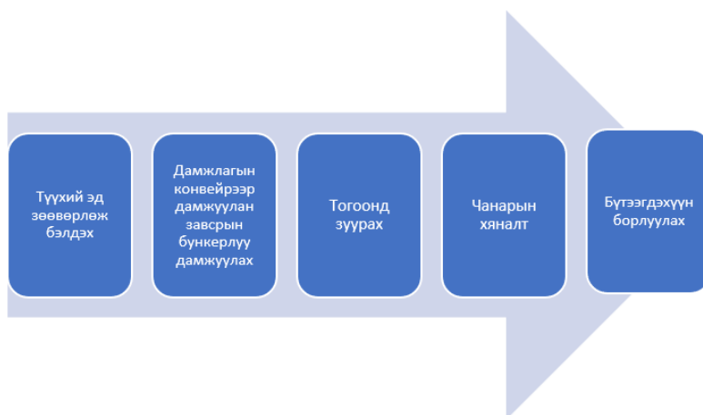
Зураг 1-4. Бетон зуурмагийн үйлдвэрийн технологийн бүтэц
