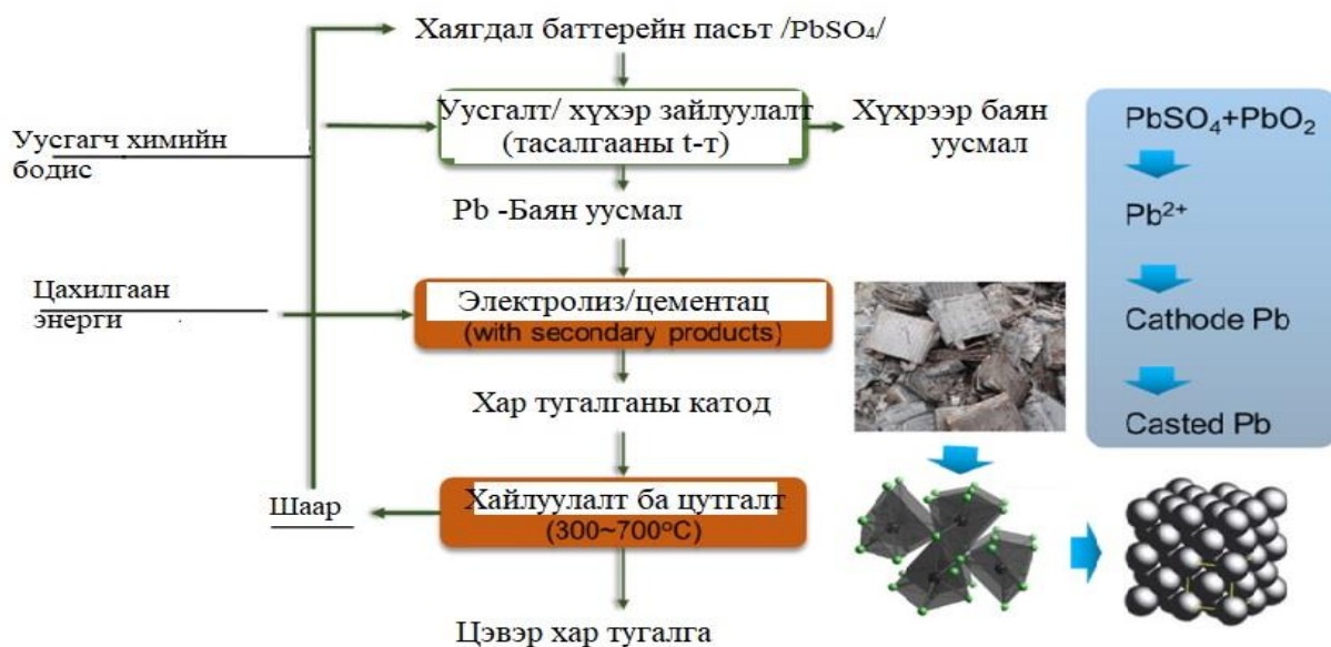
Зураг № 6 Гидрометаллургийн аргаар хаягдал цэнэг хураагуурыг дахин боловсруулах схем
