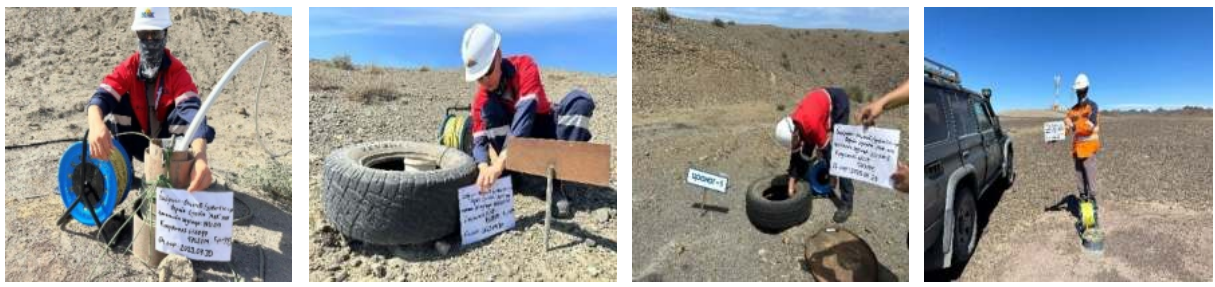
Зураг 121. Цооногт хэмжилт хийж байгаа байдал
