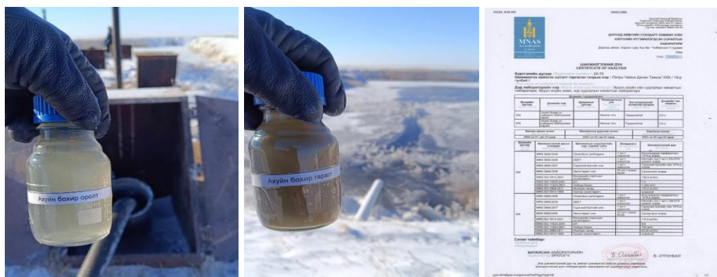
Зураг № 18. Ахуйн бохир цэвэршүүлэх байгууламжаас дээж авч буй
