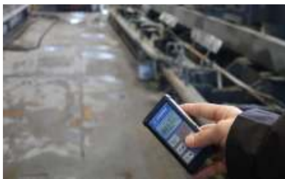
Зураг 9.4д. Ажиглалтын бүс баяжуулах үйлдвэр тээрмийн ташин гамма цацрагийн тунгийн чадлын хэмжилт
