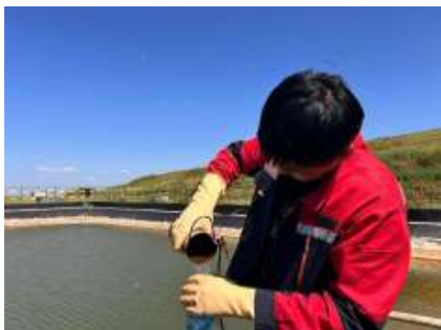
Зураг 9.2. Ундны болон үйлдвэрийн усны дээжлэлт хийж буй үе
