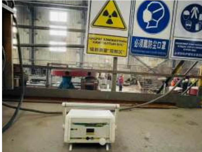
Зураг 52. Флотацн машины агаар дах радонь хуримтлалын хэмжилт
