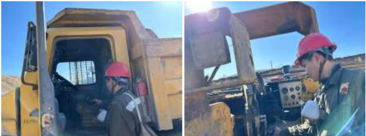
Зураг 57. Хүдэр тээвэрлэлтийн ачааны машины гадаргуугийн бохирдолтын хэмжилт
