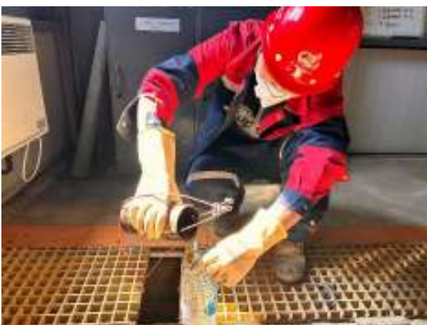
Зураг 9.2. Ундны болон үйлдвэрийн усны дээжлэлт хийж буй үе
