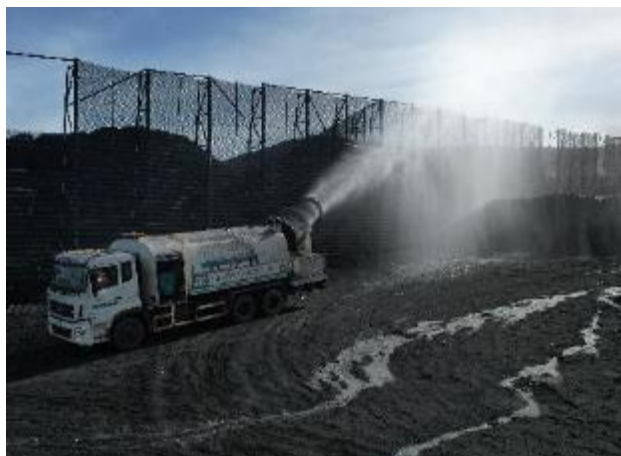
Зураг 22. Нүүрсний талбайд ажиллаж байгаа мананжуулагч машин
