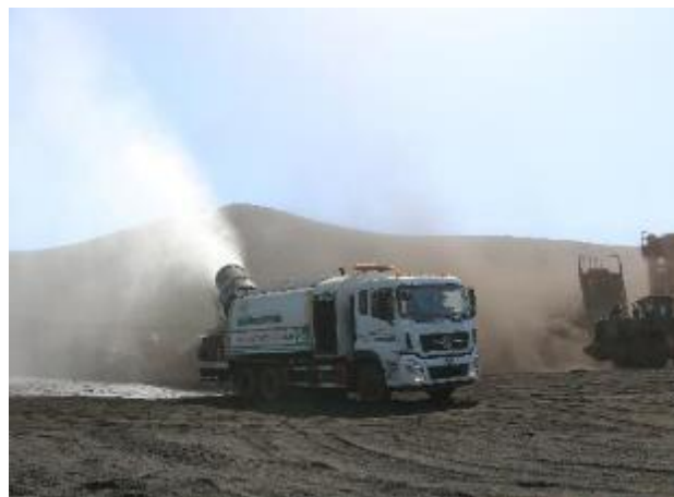
Зураг 22. Нүүрсний талбайд ажиллаж байгаа мананжуулагч машин
