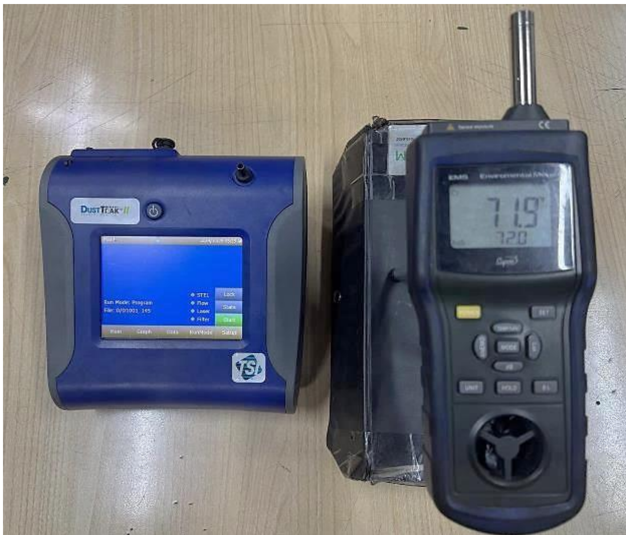
Зураг 61. Тоосонцор хэмжилтийн dusttrack багаж болон дуу шуугианы түвшин, салхины хурд хэмжигч багаж
