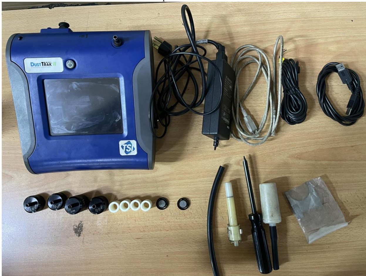
Зураг 63. Үйлдвэрийн тохиргоонд явуулсан Dast track багажийн иж бүрдэл
