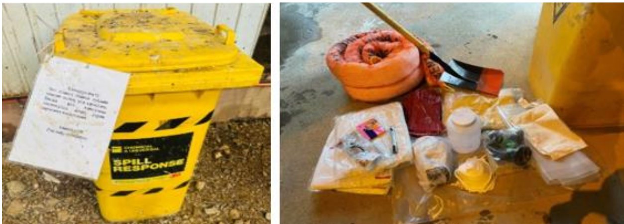
Зураг 39. Асгаралтын үед хэрэглэх шингээгч материалуудын иж бүрдэл
