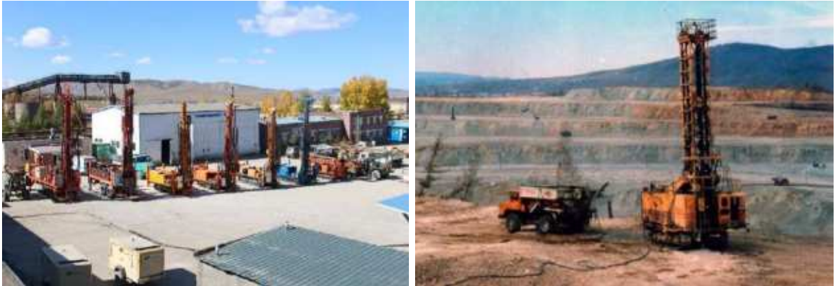
Зураг 30. Өрмийн машин болон өрөмдлөг хийж буй явц
