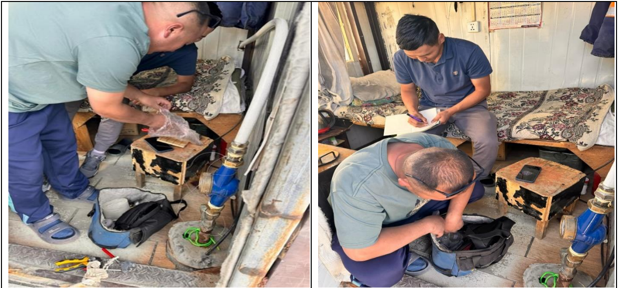
Зураг 39. Усны тоолуурын баталгаажуулалт хийгдэх үеийн хяналт
