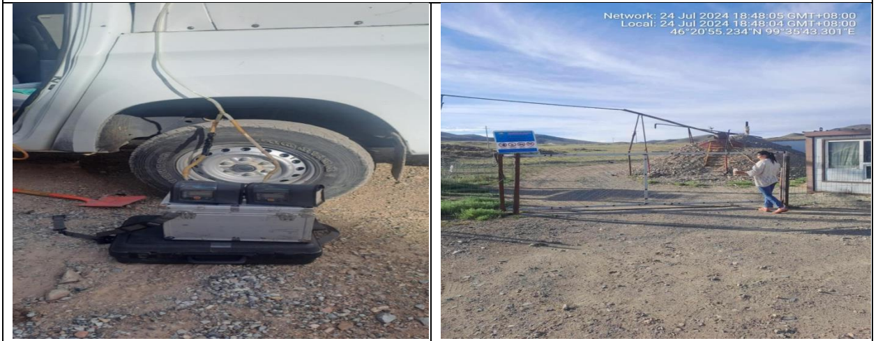
Зураг 137. DUSTRAK 8530 багажаар хэмжилт хийж байгаа нь
