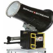
Төрөл SPRAYSTREAM 100i Зай 100 М Даралт 20 BAR Зэрүүлц 8400 L/H
