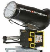
Төрөл SPRAYSTREAM 50i-60i-70i-80i Зай 50-80 М Даралт 20 BAR Зэрүүлц 2700-8500 L/H
