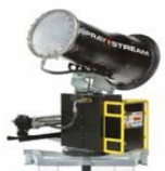
Төрөл SPRAYSTREAM 35i Зай 35 М Даралт 20-80 BAR Зэрүүлц 1200-800 L/H
