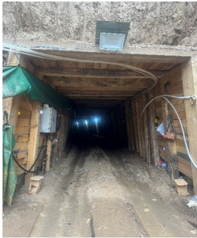
Хэвтээ амны агааржуулалтын хоолой, гэрэлтүүлэг, бэхэлгээ харагдах байдал
