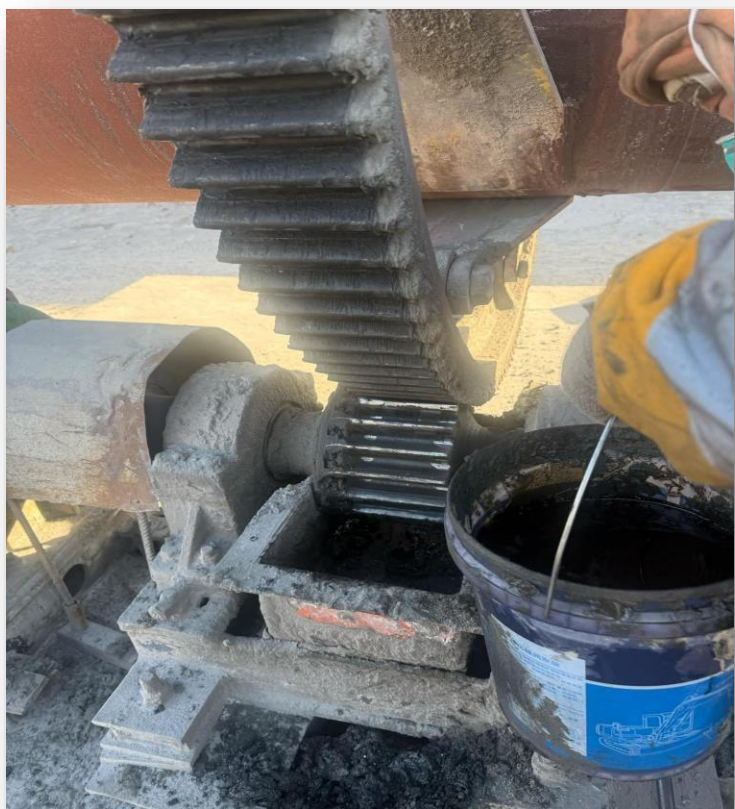
Ажилласан тос маслыг Тулгат шийр ХХК-ийн Эргэх зуухны араа булны тосолгоонд ашиглалаа.
