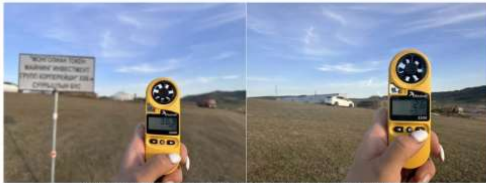
Зураг 4. Kestrel агаарын багажаар хэмжилт хийж буй байдал
