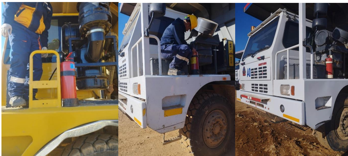
Зураг.38 Автосамсвалдуудад галын хор байруулсан байдал
