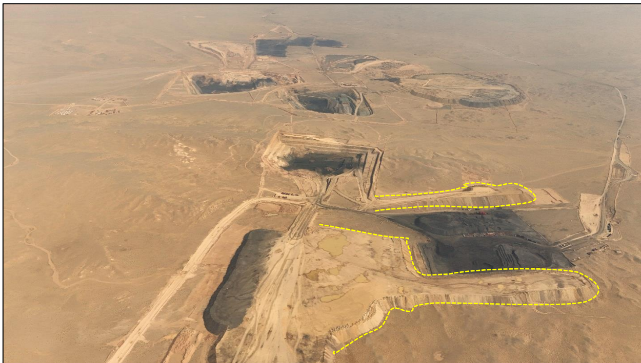
Зураг № 9. Уурхайн нүүрсний агуулахаас нүүрс салхинд хийсэхээс хамгаалж 2 талаар нь овоолго үүсгэсэн байдал
