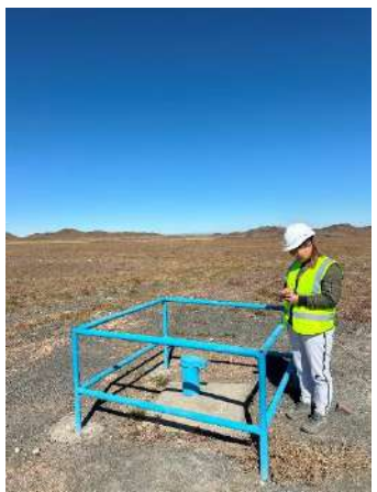
Зураг 54. Уурхайн усны хяналтын цэгийн усны түвшний үр дүнгийн график болон усны түвшний хэмжилт хийж буй байдал мөн Ноён сумын байгаль хамгаалагч хяналтын цооногийн түвшний хэмжилтийг давхар шалгаж буй нь
