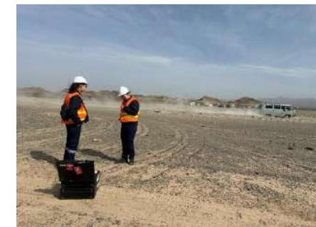
Зураг 49. Нүүрс тээврийн замын тоосны хэмжилтийн цэгүүдийн харуулсан план болон нүүрс тээврийн замд тоосны хэмжилт хийж буй байдал
