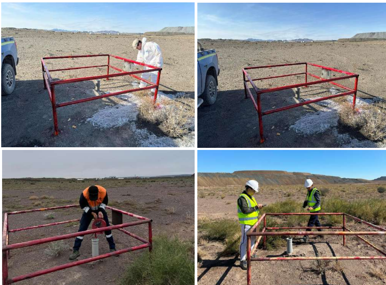
Зураг 66. Хяналтын цооногт усны түвшинд хэмжилт хийж буй нь
