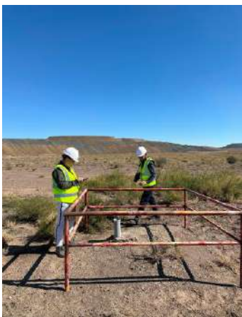
Зураг 54. Уурхайн усны хяналтын цэгийн усны түвшний үр дүнгийн график болон усны түвшний хэмжилт хийж буй байдал мөн Ноён сумын байгаль хамгаалагч хяналтын цооногийн түвшний хэмжилтийг давхар шалгаж буй нь
