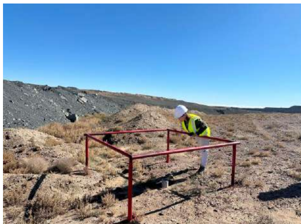
Зураг 54. Уурхайн усны хяналтын цэгийн усны түвшний үр дүнгийн график болон усны түвшний хэмжилт хийж буй байдал мөн Ноён сумын байгаль хамгаалагч хяналтын цооногийн түвшний хэмжилтийг давхар шалгаж буй нь
