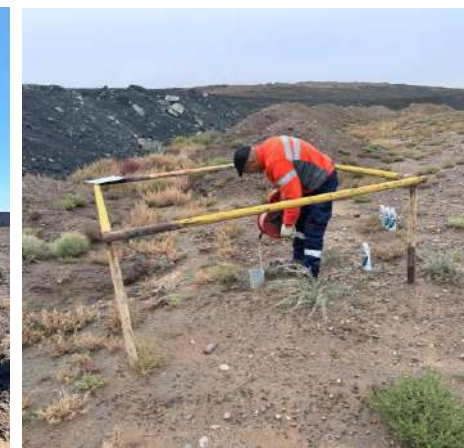
Зураг 54. Уурхайн усны хяналтын цэгийн усны түвшний үр дүнгийн график болон усны түвшний хэмжилт хийж буй байдал мөн Ноён сумын байгаль хамгаалагч хяналтын цооногийн түвшний хэмжилтийг давхар шалгаж буй нь
