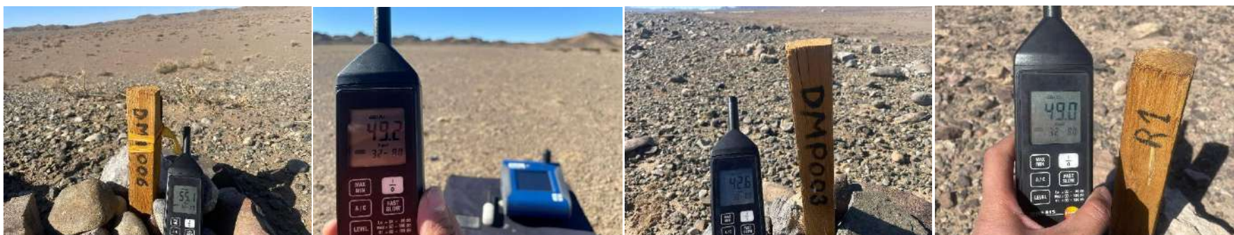
Зураг 51. Нөлөөллийн бүсийн дуу шуугианы хэмжилтийн график үзүүлэлт болон дуу чимээг зөврийн багажаар хэмжиж буй байдал
