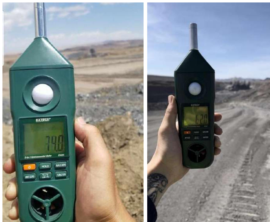
Зураг 52. Тэсэлгээний явцад 500 метр зайнаас дуу чимээг зөөврийн багажаар гүйцэтгэж буй байдал
