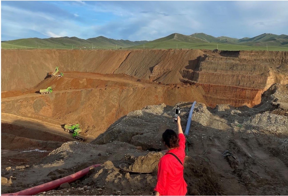
Зураг 10 Карьер, засварын талбай болон ажилчдын хотхонд тоосжилтийг хэмжиж буй байдал
