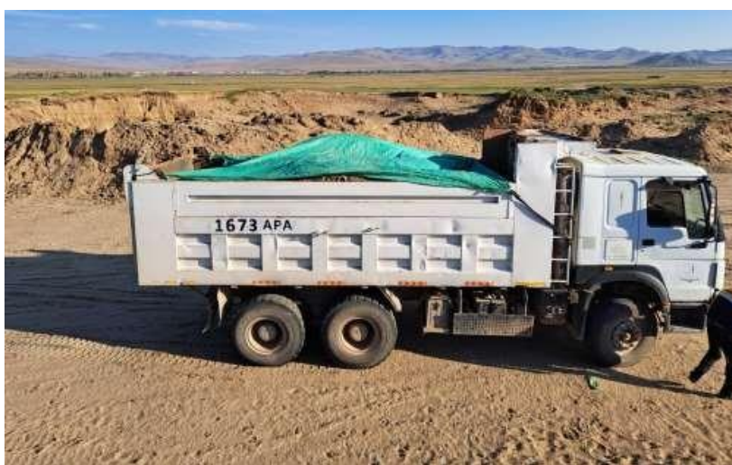
Зураг 11 Тоосжилтыг бууруулах зорилгоор элс тээврийн машины ачаанд хучилт хийж буй байдал
