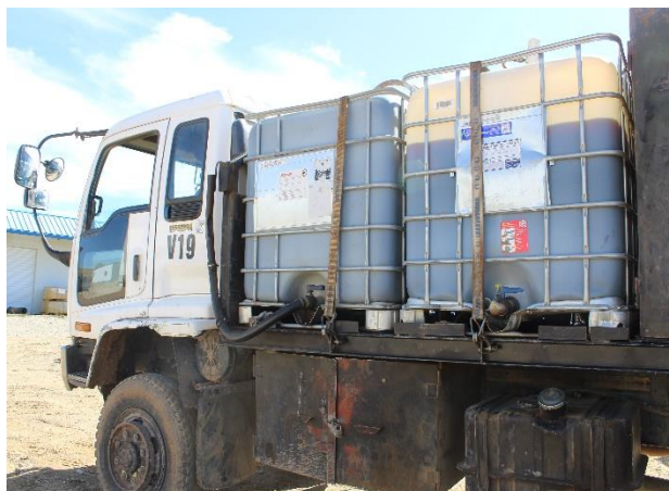
Зураг 4. Уурхайн талбайн машинистийн хаягдал тос цуглуулах машин
