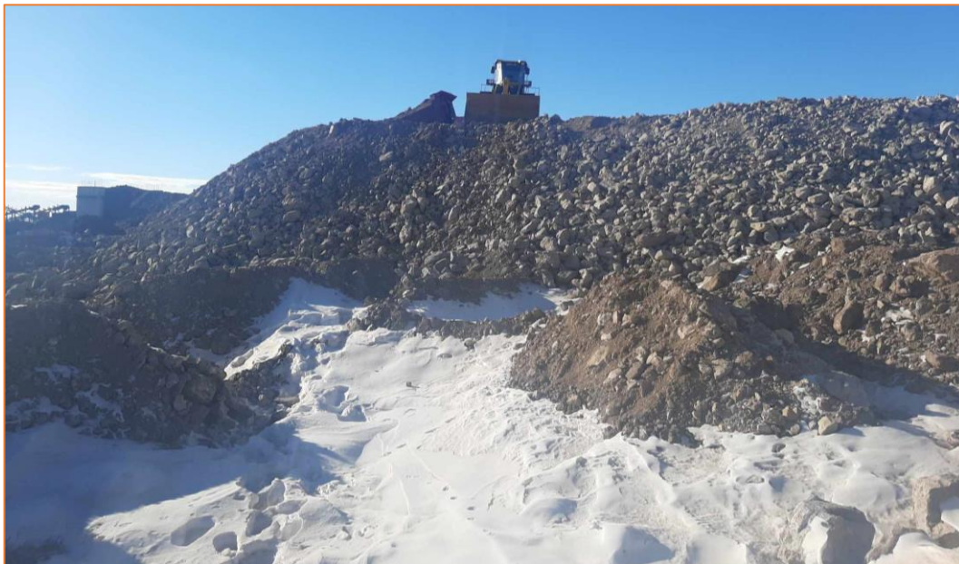
Зураг 13. Хүдрийн овоолгын хэлбэржүүлэлт хийж буй байдал
