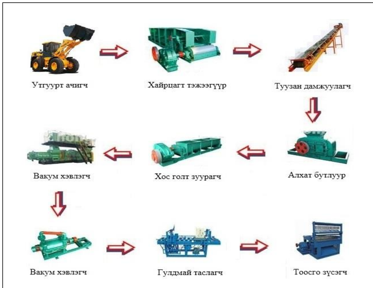
Зураг 1.3. Тоосго үйлдвэрлэлийн тоног төхөөрөмжийн дамжлага схем
