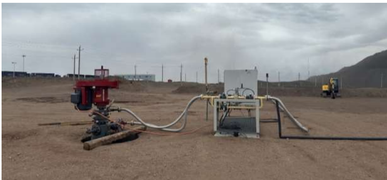
Зураг 10. Туршилт-олборлолтын цооногийн хажууд хий, шингэний урсгал хэмжигч багц тоног төхөөрөмжийг суурьлуулсан байдал
