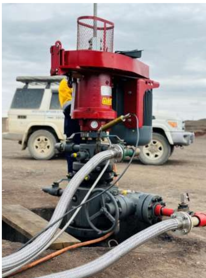
Зураг 9. Туршилт олборлолтын цооногийн хөтлөгч мотор (drivehead) суурьлуулсаны дараах байдал
