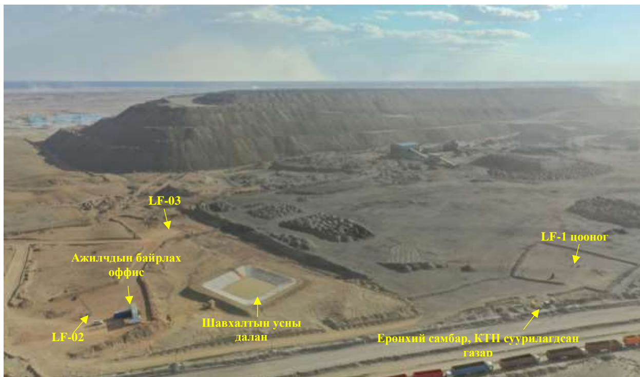
Зураг 13. Туршилт-олборлолтын цооногийн талбайд байгуулагдсан шавхалтын ус түр цуглуулах далан болон туршилт-олборлолтын цооногуудын байрлалыг харуулсан дрон зураг
