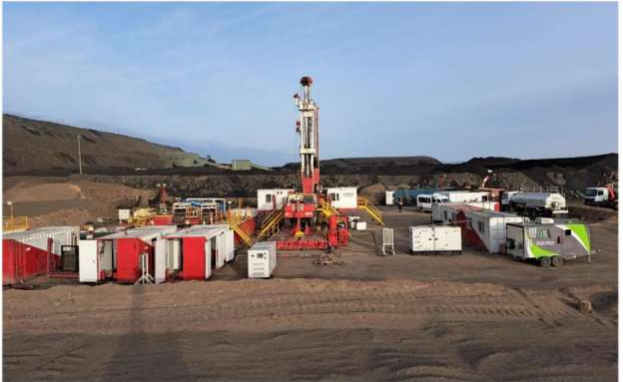
Зураг 4. Туршилт-олборлолтын цооног (LF-02) өрөмдлөг хийх явц
