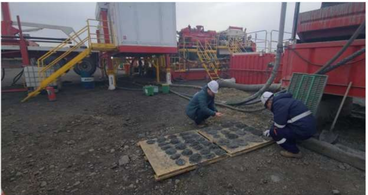
Зураг 5. Туршилт-олборлолтын цооног (LF-01)-оос үртсэн дээжлэл хийх явц
