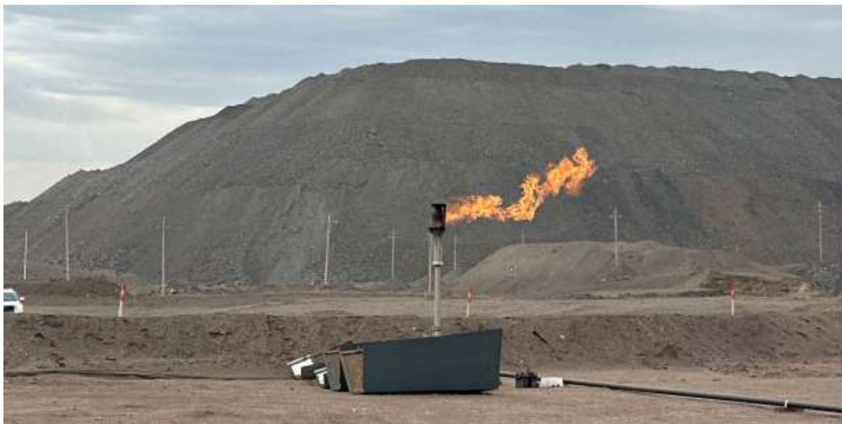
Зураг 11. Туршилт олборлолтын цооногийн хажууд бамбарлан шатаах төхөөрөмж суурилуулсан байдал
