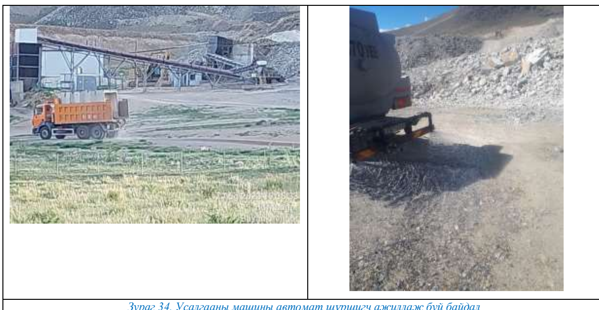
Зураг 34. Усалгааны машины автомат шүршигч ажиллаж буй байдал
