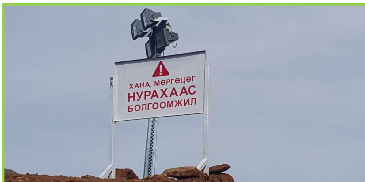
Зураг №9: Шөнийн ээлжинд ажиллахад уурхайн хананы нуралт болон зам талбайг гэрэлтүүлсэн гэрэлтүүлэг
