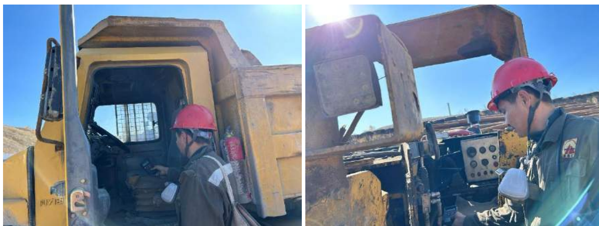
Зураг 54. Хүдэр тээвэрлэлтийн ачааны машины гадаргуугийн бохирдолтын хэмжилт
