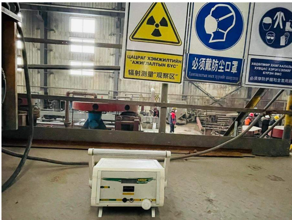
Зураг 48. Флотацн машины агаар дахь радоны хуримтлалын хэмжилт
